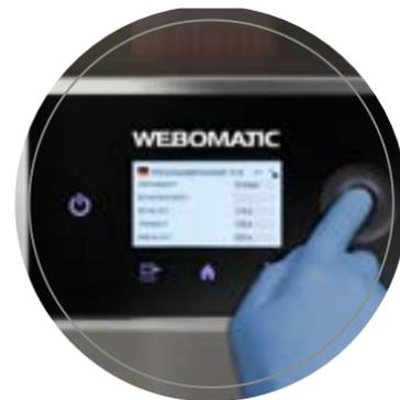
Los controladores IGT miden absolutamente el vacío, el EAP, el aire suave y cuentan con tres programas de vacío específicos para los productos:
