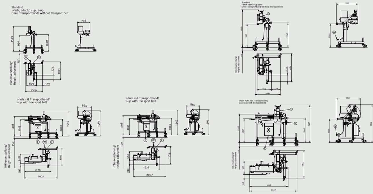
Dibujo técnico A = conexión de aire E = conexión eléctrica W = conexión de agua
