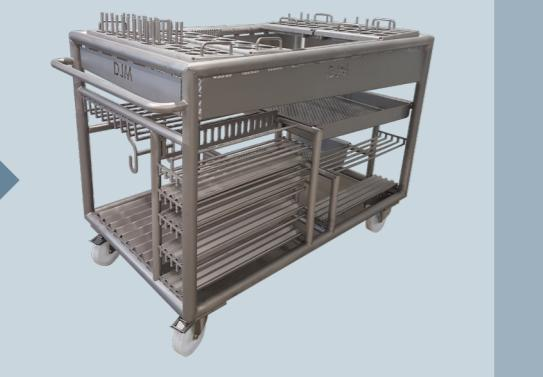
Para garantizar un posicionamiento y almacenamiento profesional durante la limpieza y el secado de todas las piezas que han estado en contacto con alimentos durante la producción, DJM desarrolló este carro de limpieza de diseño específico. Al colocar las piezas en ángulo, se limpian de forma óptima, mientras que el agua se escurre fácilmente, acelerando así el proceso de secado.
