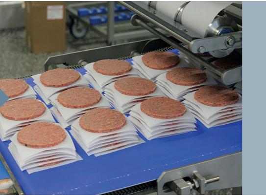
Los modelos VacForm VF04 y VF06 pueden equiparse con un sistema de intercalación de papel opcional. Este sistema...
